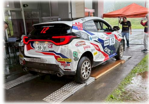
車検項目の車両重量を測定中
